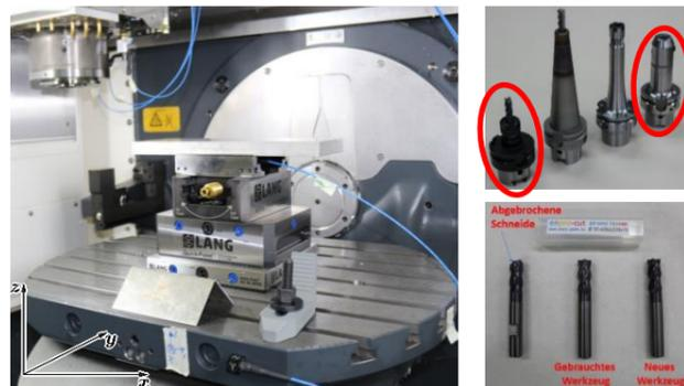
Abbildung 1: Messaufbau mit verwendeten Werkzeugen und Werkzeugaufnahmen
