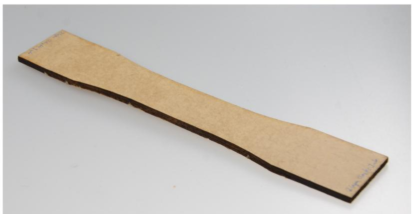
Abbildung 4: Zugprobe aus naturfaserverstärktem Papier
