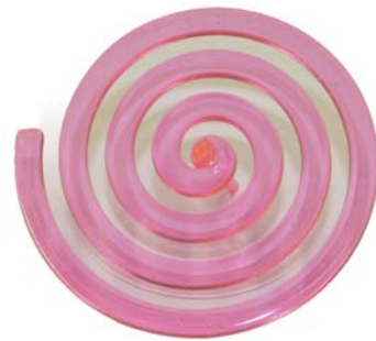
Fließspirale mit Anguss
