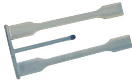
Zugstäbe Typ 1A mit Anguss
