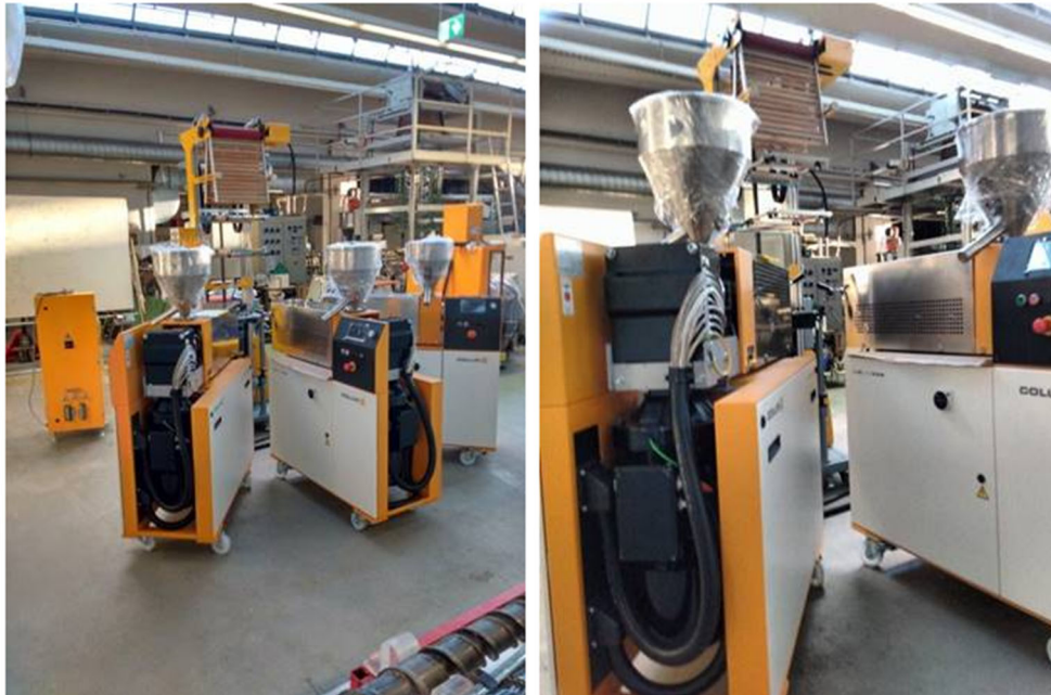
Abb.: Fotos der neuen Labor-Blasfolien-Anlage während des Aufbaus im Technikum des FBMK
