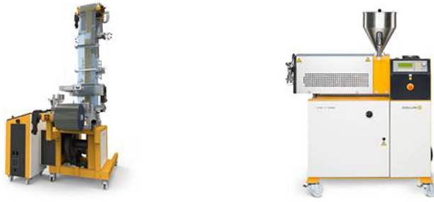
Abb.: LINKS: Seitenansicht der COEX-Laborblasfolienanlage RECHTS: Seitenansicht einer der 3 Extruder ESE 30E
